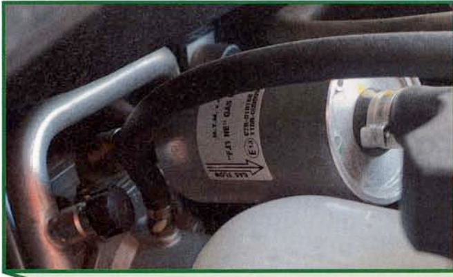
Il motore 1.0 da 68 cv lascia poco spazio nel vano per i dispositivi GPL, come il riduttore e il filtro del gas.
